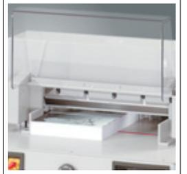
Le carter avant actionnant une sécurité électrique, positionné au-dessus de la table de travail, se soulève aisément.
